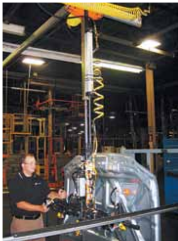
Drehmomentrohr mit integriertem Vakuum-Handhabungssystem
